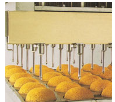
Iniettatrice modello DPV per la farcitura di una teglia da mm 600x600 Depositor model DPV to fill one 600x600 mm tray of products per cycle
