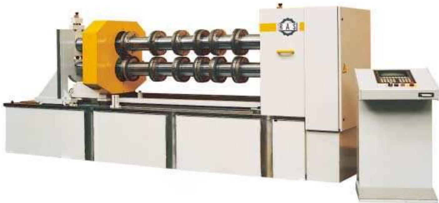
■ Zusätzlich zur manuellen Messerverstellung bei der RAS 59.50 bringt der integrierte Wechselroboter der RAS 59.62 VARIOCUT bis zu 6 Rollenmesserpaare innerhalb 2 bis 3 Minuten auf die gewünschte Position und stellt automatisch den richtigen Schnittpalt ein.
