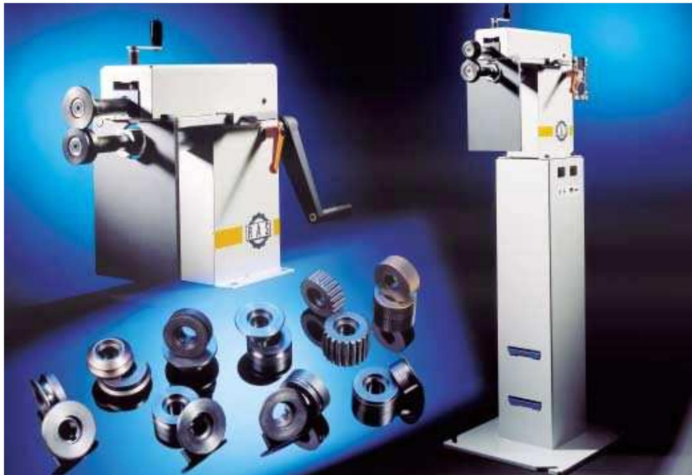
■ Die motorisch oder manuell angetriebenen Sickenmaschinen beinhalten schon in der Grundausstattung 9 Walzenpaare und einen Anschlag mit geteilter, großer Anschlagplatte. Die Geschwindigkeit lässt sich über den Fußschalter stufenlos regeln (RAS 11.35).
