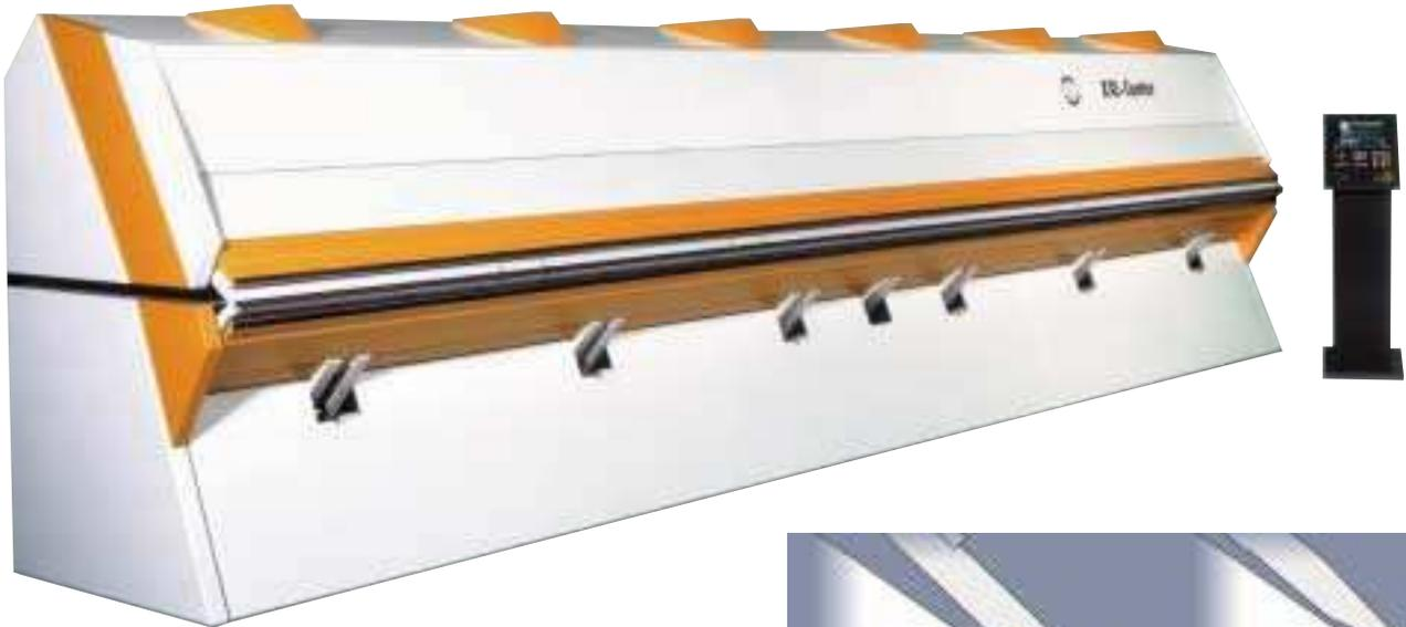
■ Das weltweit erste Biegezentrum für Langbiegeteile automatisiert den gesamten Biegeablauf. Die Maschine zieht das Blech automatisch ein, richtet es aus, Greiferzangen positionieren es automatisch und das Biegezentrum biegt es nach oben und unten. Das XXL-Center fertigt Präzisionsbiegeteile automatisch und in Rekordzeit und eliminiert den Bedienerinfluss auf das Biegeergebnis. Die CADalyzer-Programmierung ist grafisch unterstützt und erlaubt eine Simulation des Biegeablaufs.
